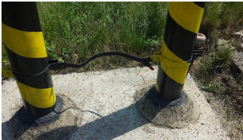
Obrázek 9 – Měření směsného potenciálu Uz – trakční stožár
